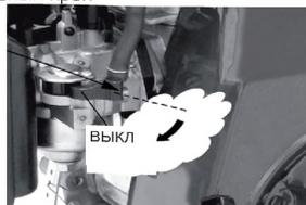
3. Закройте топливный краник - положение OFF (закрыто) (рис. 13).
